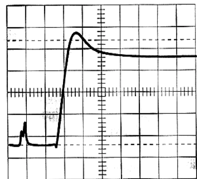
Kuva 28 Yläkuvassa normaali näyttö ja alakuvassa vastaava pretrigger-näyttö. Tahdistus on kiinnitetty transientin nousevaan osaan, joka näkyy yläkuvan vasemmassa laidassa.
